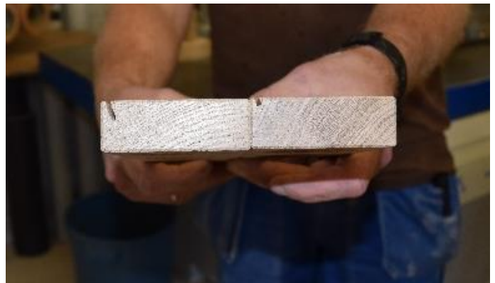
Das Fräsen der Nut erfolgt in zwei Arbeitsschritten
